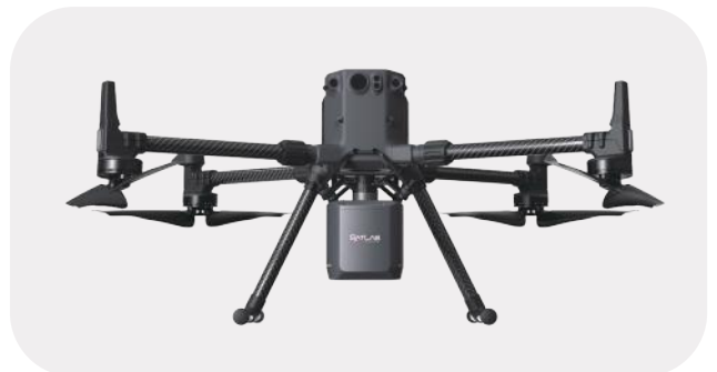
Figure 3. DJI M350 RTK + Apus-MX LiDAR
